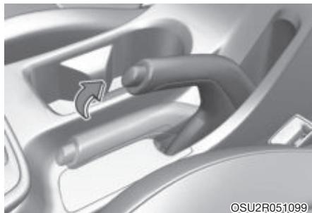
Проверьте ход рычага стояночного тормоза, подсчитав количество щелчков, слышимых при полном его включении из выключенного положения.
