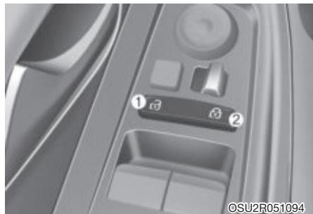
При нажатии на (1) часть (1) переключателя производится блокирование всех дверей.
