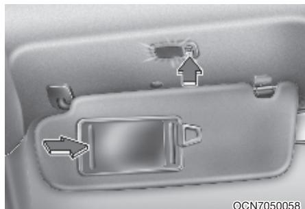
Нажмите этот выключатель для включения или выключения лампы.
