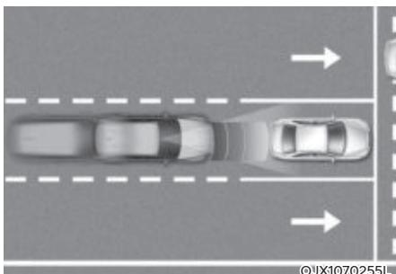
Система предотвращения фронтального столкновения предназначена для помощи в обнаружении и контроле транспортного средства впереди, а также пешеходов и велосипедистов на проезжей части и предупреждает водителя о неизбежном столкновении посредством вывода сообщения на дисплей и подачи звукового сигнала и при необходимости осуществляет экстренное торможение.
