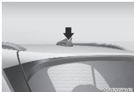
Антенна «акулий плавник» принимает передаваемые данные (например, сигналы АМ/FM-радиостанций).
