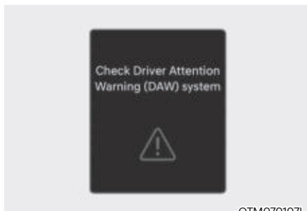
Если система контроля внимания водителя работает ненадлежащим образом, на комбинации приборов на несколько секунд появляется предупреждающее сообщение «Проверьте систему контроля внимания водителя (DAW)» и загорается главная контрольная лампа аварийного состояния (!). Если это происходит, рекомендуем проверить систему контроля внимания водителя у авторизованного дилера HYUNDAI.
