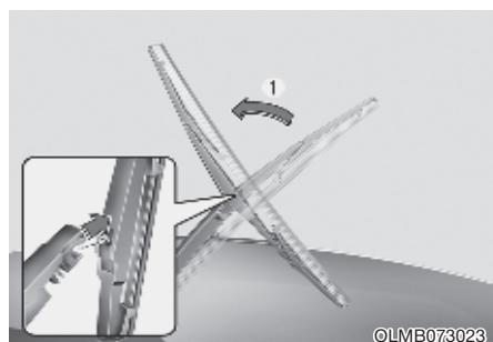
1. Поднимите рычаг стеклоочистителя и поверните щетку (1).
