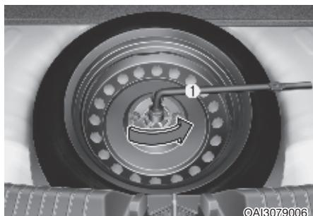
Если сложно вывернуть прижимной барашковый болт колеса вручную, его можно легко вывернуть, используя баллонный ключ.
