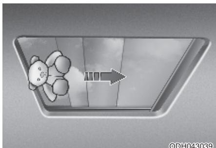
Если при автоматическом закрытии солнцезащитной шторки / панели люка будет обнаружено препятствие, солнцезащитная шторка / панель люка остановится и переместится в противоположном направлении, давая возможность удалить объект.
