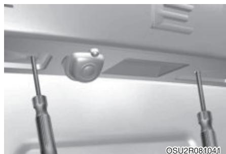
1. Выверните винты крепления фонаря отверткой с крестообразным шлицем.
