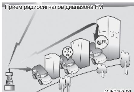
AM и FM радиосигналы передаются с высотных радиопередатчиков, расположенных вокруг города. Они улавливаются радиоантенной вашего автомобиля. Этот радиосигнал обрабатывается радиоприемником и передается на динамики автомобильной аудиосистемы.
