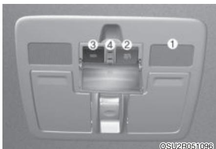
Компоненты системы ЭРА-ГЛОНАСС, установленные в салоне автомобиля:
