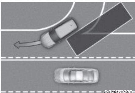
Система предупреждения о столкновении с объектом вне зоны видимости водителя может работать ненадлежащим образом при движении на участке слияния или разделения дороги. Система предупреждения о столкновении с объектом вне зоны видимости водителя может не обнаруживать транспортное средство, движущееся по соседней полосе.
