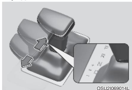
Чтобы активировать режим ручного переключения передач, следует (при неподвижном или движущемся автомобиле) перевести рычаг селектора из положения D (движение) в сектор ручного переключения. Для возврата в режим D (дви-
