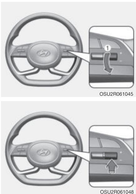
Для возобновления действия ограничителя скорости с ручным управлением после его приостановки переведите переключатель вверх (+) или вниз (-) или нажмите переключатель .
