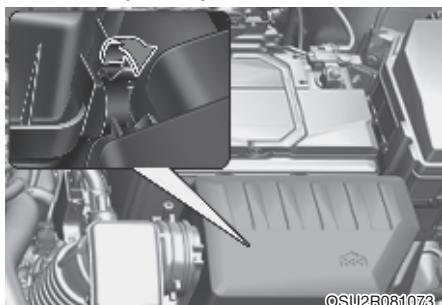
Воздушный фильтр для проверки можно очистить сжатым воздухом. Не пытайтесь промывать или прополоскивать его, так как это приведет к повреждению фильтра.
