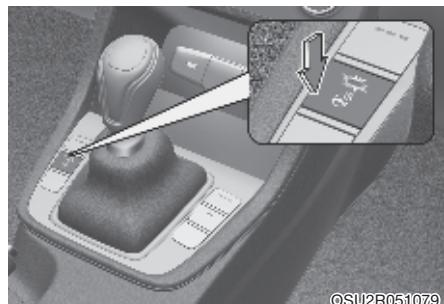
Обогрев рулевого колеса включается нажатием кнопки при включенном зажигании или при работающем двигателе.
