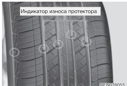
Если шина изношена равномерно, то индикатор износа появится в виде сплошной полосы, расположенной поперек протектора. Она означает, что на шине остался слой протектора толщиной менее 1,6 мм (1/16 дюйма). Если это произошло, замените шину.
