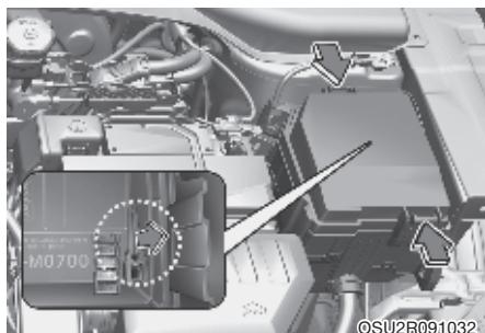
3. Извлеките предположительно неисправный предохранитель, потянув его в направлении под прямым углом к панели. Для извлечения плавких предохранителей из панели в отсеке двигателя используйте приспособление, входящее в комплект поставки автомобиля.
