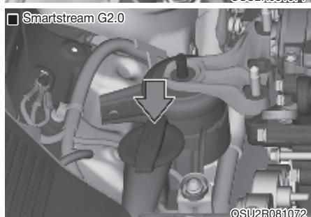
Проверьте уровень жидкости в бачке омывателя и долейте жидкость, если необходимо. При отсутствии специального раствора можно использовать чистую воду. Однако в районах с холодным климатом следует использовать незамерзающие моющие растворы.
