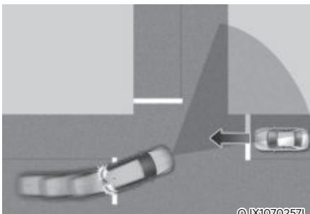
Функция предотвращения столкновения при повороте на перекрестке помогает избежать столкновения с встречным транспортным средством, движущимся по соседней полосе и поворачивающимся налево на перекрестке с включенным указателем поворота, путем осуществления экстренного торможения.
