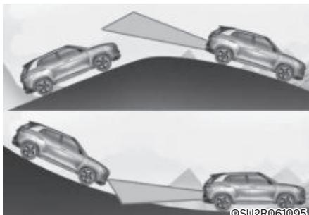
Система предупреждения о столкновении с объектом вне зоны видимости водителя может работать ненадлежащим образом при движении на уклоне. Система предупреждения о столкновении с объектом вне зоны видимости водителя может не обнаруживать транспортное средство, движущееся по соседней полосе, или подавать ложные предупреждения при обнаружении грунта или сооружения.
