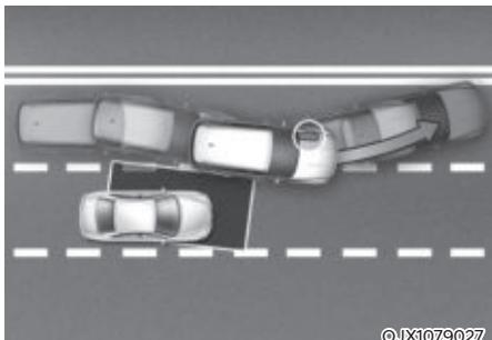
При смене полосы движения во время слежения за полосой движения впереди система предупреждения о столкновении с объектом вне зоны видимости водителя распознает опасность столкновения с приближающимся транспортным средством, движущимся в непросматриваемой зоне, и помогает избежать столкновения путем воздействования тормозов.
