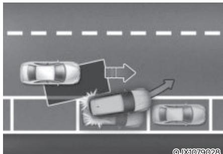
Если при выезде передним ходом с места для парковки система предупреждения о столкновении с объектом вне зоны видимости водителя распознает опасность столкновения с приближающимся транспортным средством, движущимся в непросматриваемой зоне, система помогает избежать столкновения путем воздействования тормозов.
