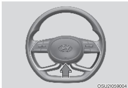
Для включения звукового сигнала нажмите на зону на рулевом колесе, обозначенную соответствующим символом (см. рисунок). Звуковой сигнал будет работать только во время нажатия на эту зону.
