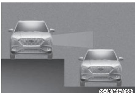
Система предупреждения о столкновении с объектом вне зоны видимости водителя может работать ненадлежащим образом при движении на участке с разной высотой полос движения. Система предупреждения о столкновении с объектом вне зоны видимости водителя может не обнаруживать транспортное средство на дороге с разной высотой полос движения (участки с разделением уровней, транспортные развязки и т. д.).
