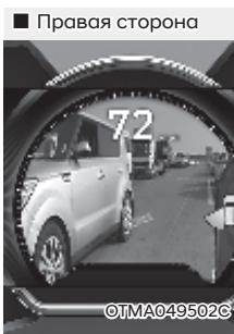
Система обнаружения объектов вне зоны видимости водителя отображает непросматриваемую зону сзади автомобиля на комбинации приборов при включенном указателе поворота для помощи при перестроении.
