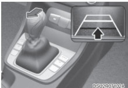
Камера заднего вида выводит на дисплей изображение пространства позади автомобиля для помощи водителю при парковке или движении задним ходом.
