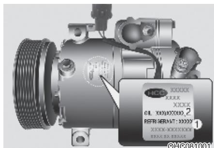
На этикетке компрессора указаны модель, номер по каталогу поставщика и серийный номер компрессора, тип хладагента (1) и тип компрессорного масла (2).
