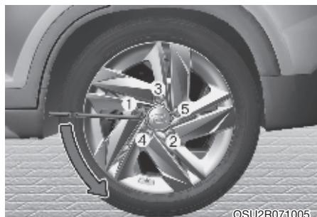
6. Ослабьте против часовой стрелки гайки крепления колеса, но не откручивайте их полностью, пока колесо не будет поднято над землей.
