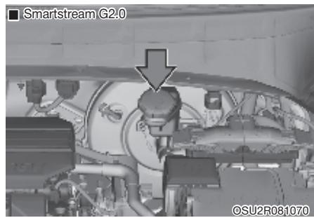
Периодически проверяйте уровень жидкости в бачке. Уровень жидкости должен находиться между рисками «MAX» (максимум) и «MIN» (минимум) на боковой поверхности бачка.
