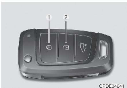
В автомобиле HYUNDAI применяется пульт дистанционного управления, который можно использовать для блокировки или разблокирования дверей (включая дверь багажного отделения) и даже для запуска двигателя.
