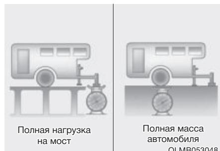
Вертикальная нагрузка от дышла прицепа — важный показатель, поскольку он входит в расчет полной массы автомобиля. Вертикальная нагрузка от дышла прицепа должна составлять не более 10% от общей массы груженого прицепа, но не превышать максимально разрешенной вертикальной нагрузки.
