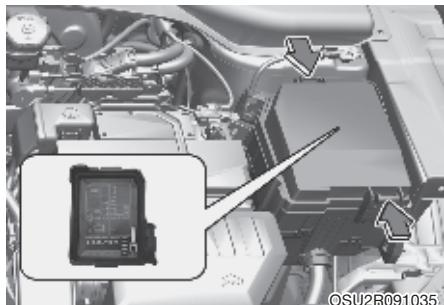
Под крышкой блока плавких предохранителей / реле находится табличка с наименованиями предохранителей/реле и значениями их номинального тока.
