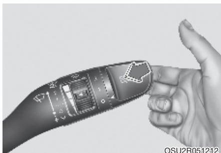
При нахождении рычага в положении 0 (Выкл.) слегка потяните его на себя для подачи жидкости на ветровое стекло и включения стеклоочистителей на 1–3 цикла работы. Работа стеклоомывателя и стеклоочистителя будет продолжаться до тех пор, пока вы не отпустите рычаг.
